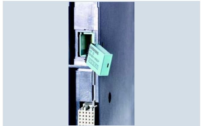
Enchufe del C-PLUG en la parte posterior del CP 443-1 Advanced
