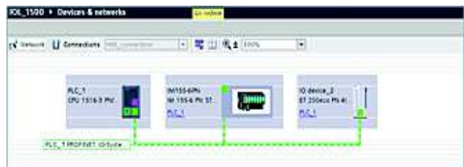
Configuración de una red PROFINET con maestros IO-Link subordinados
