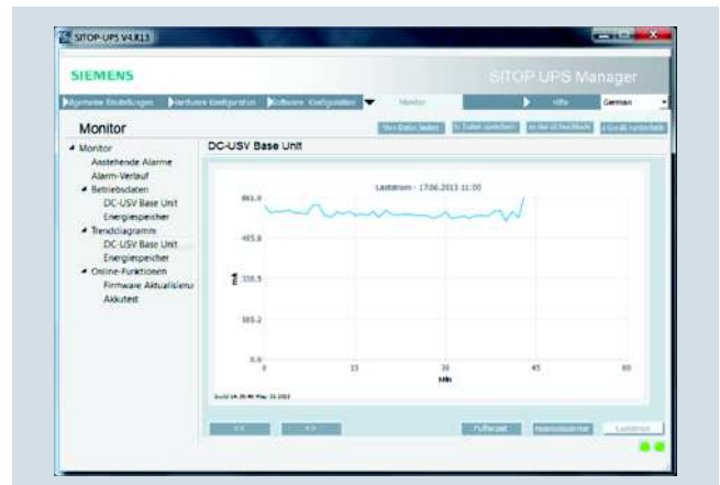
Diagrama de tendencia de la intensidad de carga en SITOP UPS Manager
