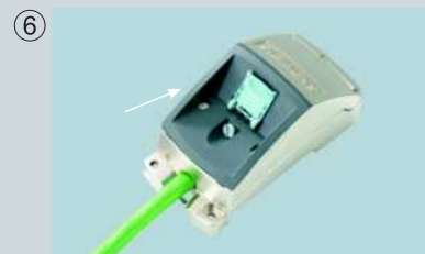
Empujar el inserto a la posición final. Apretar los tornillos de cierre de la descarga de tracción, encajar inserto, apretar tornillo elevador
