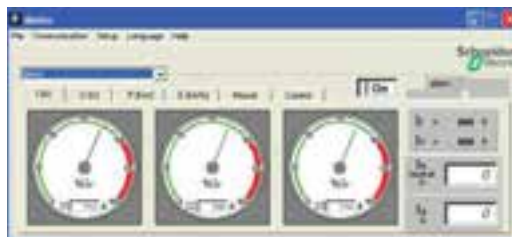
Pantalla de mini-supervisión de RCU para las medidas de corriente.
