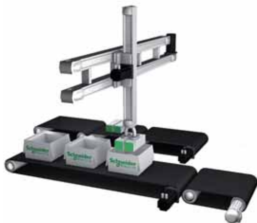
Robot de pick and place controlado por un servodrive LXM 32.
