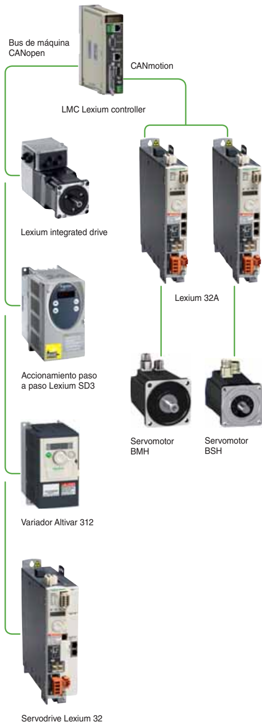
Ejemplo de arquitectura de sistema de control con buses de máquina CANopen y CANmotion.
