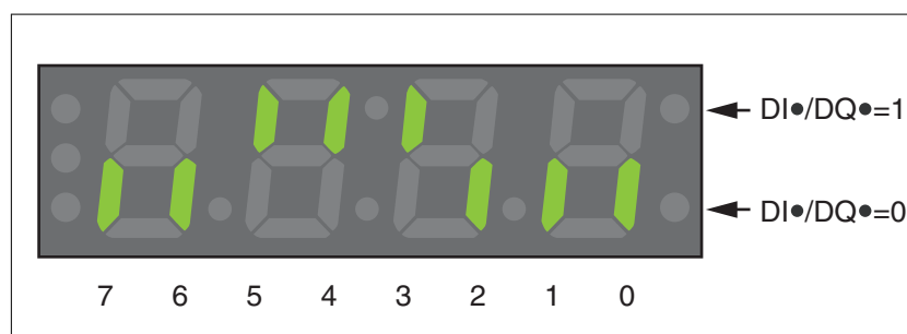
Ilustración 49: HMI integrada, mostrar estados de señales de las entradas (DI•) y salidas (DQ•) digitales
