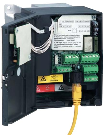
Herramientas y redes de comunicación para integración en sus sistemas de control vía conector RJ45 universal.
