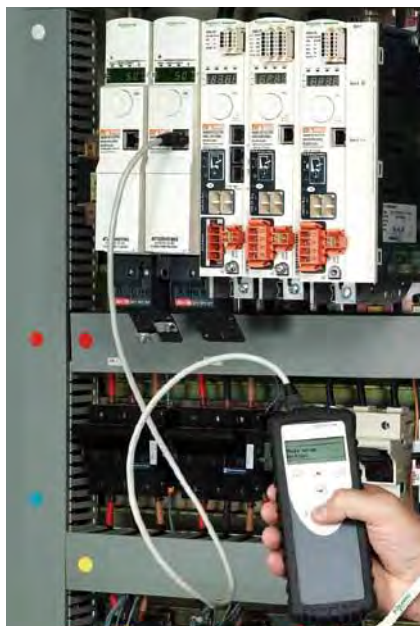
Multi-Loader Configuración y almacenaje de archivos de configuración de diversos variadores en una tarjeta SD.
