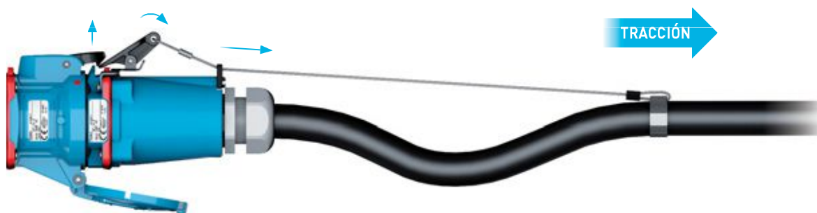
Etapa 2: La tracción actúa sobre el cable eléctrico y sobre el hilo de acero. El gatillo de eyección levanta progresivamente el trinquete de la base.
