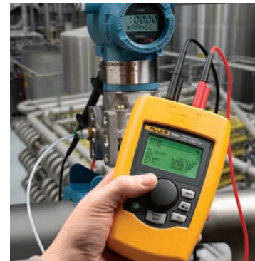
Los calibradores de lazo de Fluke son instrumentos fiables y precisos. El 709H incorpora funciones de comunicación HART básicas (véase página 16).
