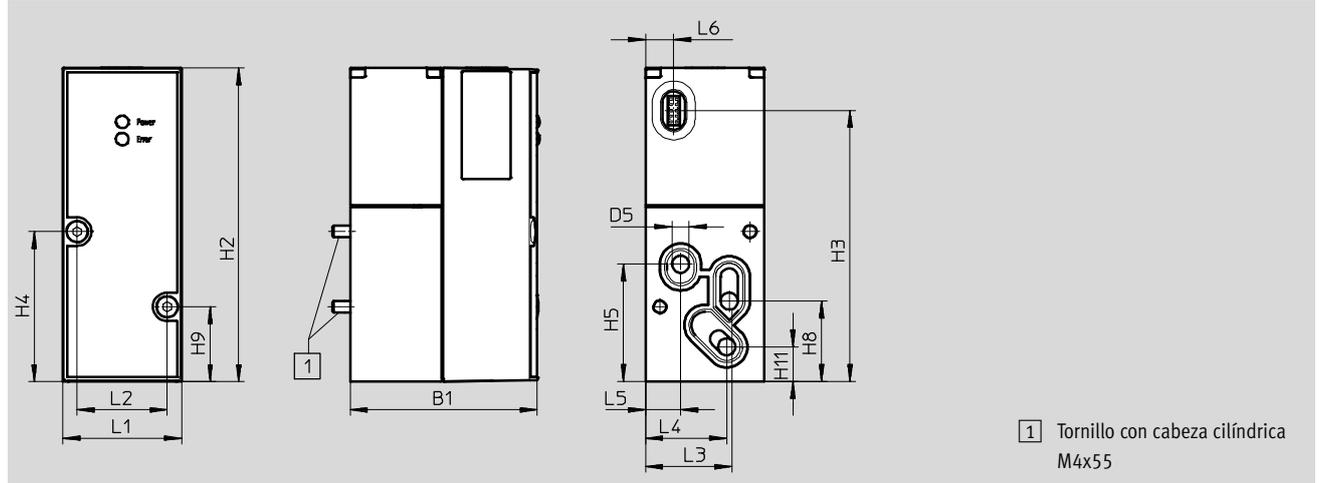
1 Tornillo con cabeza cilíndrica M4x55
