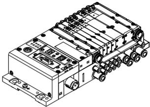
Los controles integrados en los terminales de válvulas de Festo permiten la creación de unidades de mando independientes (stand alone) con IP65 y sin armario de distribución.
