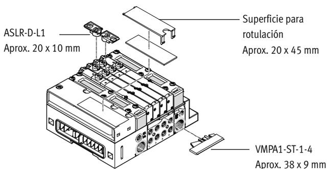
Para identificar las válvulas puede montarse en cada placa de alimentación de 42 mm de ancho un portaetiquetas VMPA1-ST-1-4 o VMPA1-ST-2-4 (se pueden equipar con placas de identificación IBS-6x10). El portaetiquetas ASLR-D-L1 se puede colocar en el accionamiento manual
