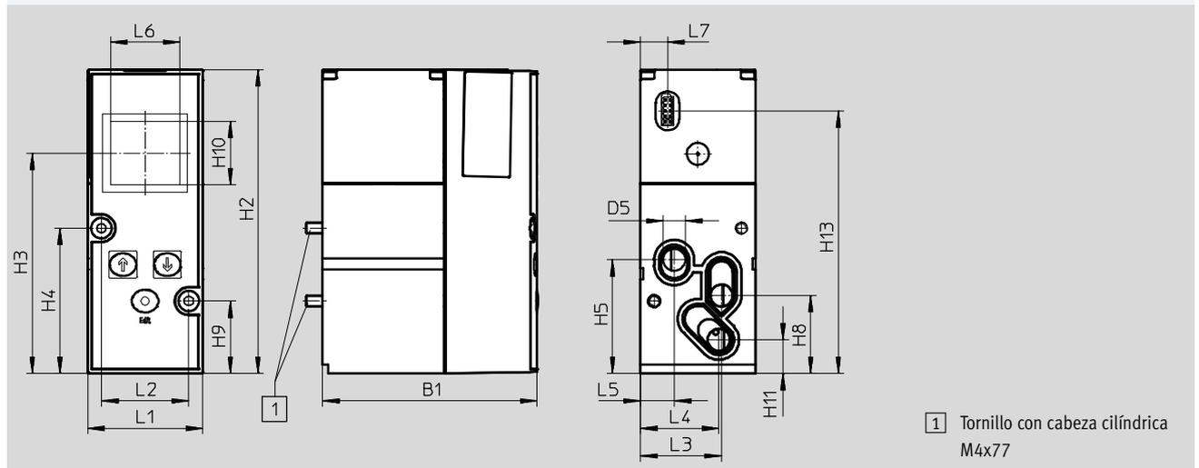
1 Tornillo con cabeza cilíndrica M4x77
