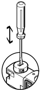
El accionamiento manual auxiliar se acciona presionando con un pasador o con un destornillador y regresa a su posición mediante reposición por muelle (la posición bloqueada se evita mediante la tapa ciega codificada). En el menú de selección Accionamiento manual auxiliar del configurador de terminales de válvulas, se pueden encargar válvulas equipadas con una tapa ciega (código N).
