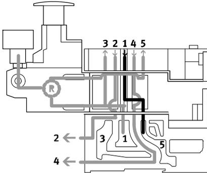
El regulador A reversible distribuye el aire de trabajo en el canal 1 y regula la presión delante de la válvula en el canal 5 (en el canal 3 se aplica la presión no regulada del canal 1).
