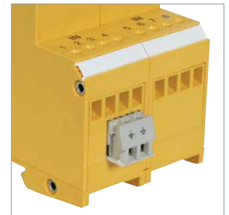
Conexión de tierra separada en el lado no protegido del dispositivo. El segundo espacio de la borna doble permite realizar la equipotencialidad directa con el equipo final.
