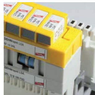
Descargador modular que consta del bastidor con los descargadores de gas, el carril de protección de puesta a tierra y los módulos de protección específicos para cada hilo.
