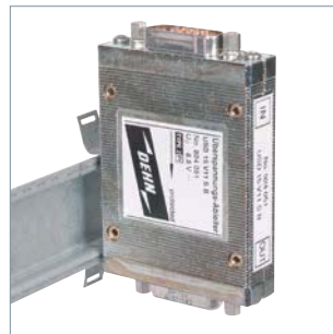
Montaje sobre un carril DIN. La sobretensión se descarga a través del carril.
