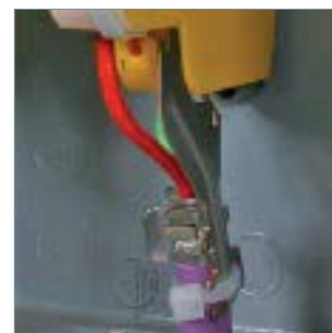
Borna de contacto elástica EMC para apantallamiento, de baja impedancia.
