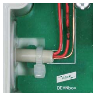
Fijación del conductor mediante bridas de cable.
